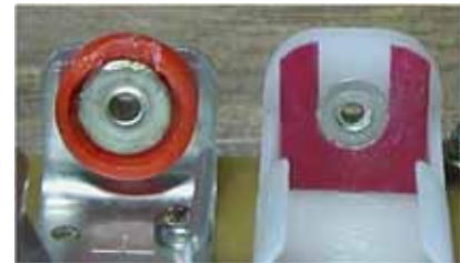
写真 4 電池の逆挿入防止用のプロテクター
